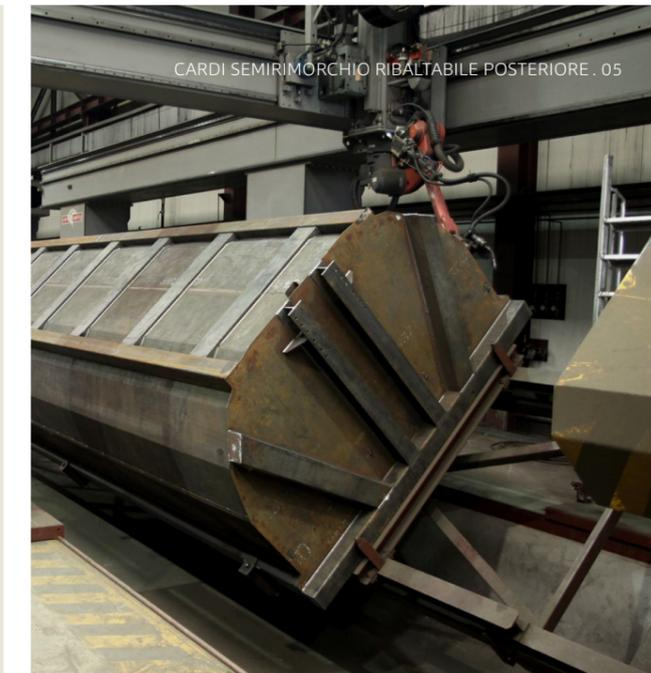
Ciclo di saldatura robotizzata nella costruzione delle casse ribaltabili
