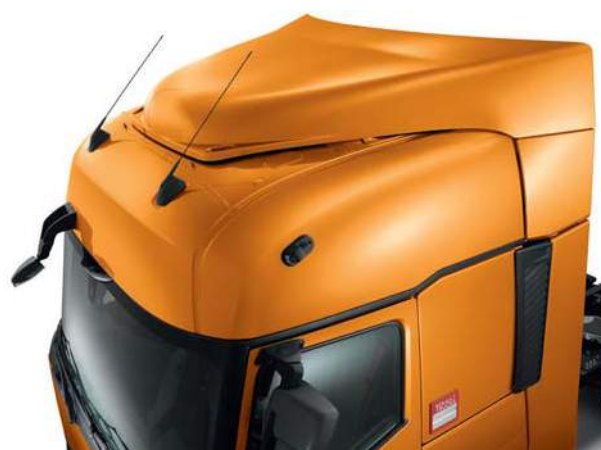
DIVERSI TIPI DI DEFLETTORI PER IL TETTO fissi (88 mm), regolabili (da 285 a 496 mm) e deflettori laterali ripiegabili.
