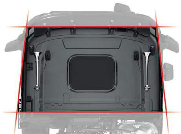
CABINA A FORMA DI TRAPEZIO 2,3 m davanti e 2,5 m dietro per favorire il flusso dell'aria.
