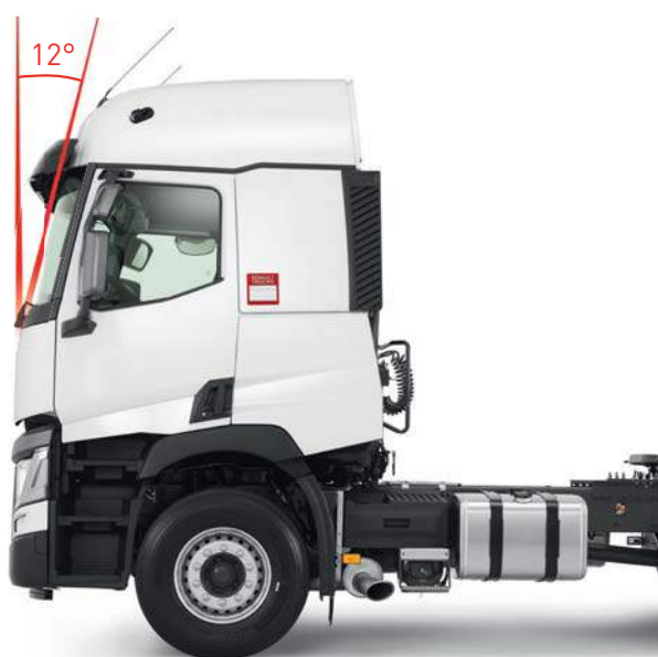
PARABREZZA INCLINATO DI 12° per una migliore aerodinamicità.
