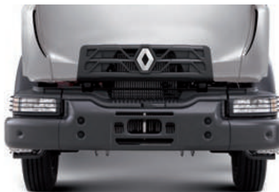
PROTEZIONE INFERIORE 100% ACCIAIO (D) per un uso gravoso.
