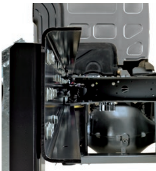
LONGHERONI TELAIO acciaio ad alta elasticità.
