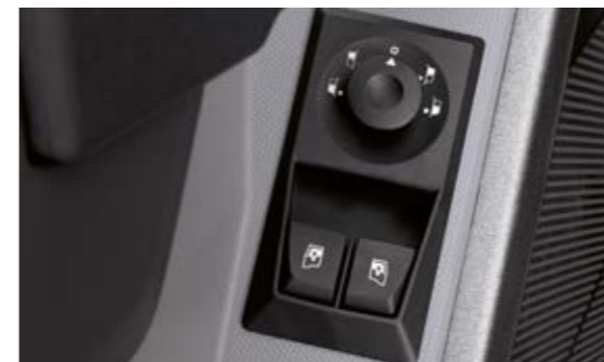
GESTIONE DEI CRISTALLI E RETROVISORI LATERALI alzacrystalli ad impulsi e regolazione elettrica dei retrovisori principali e grandangolari.
