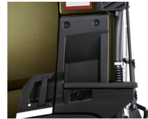
GRADINO LATERALE DI ACCESSO ALLA CARROZZERIA per verificare facilmente il contenuto del carico.
