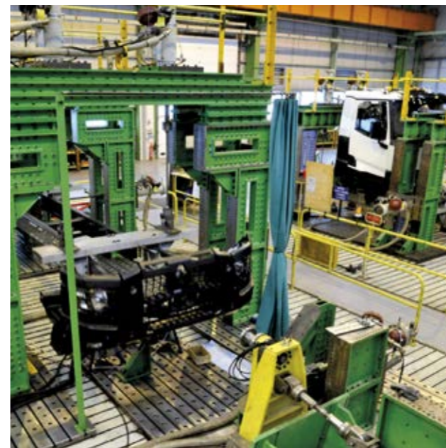
BANCHI VIBRAZIONI con migliaia di ore di prove per garantire l'affidabilità della cabina.
