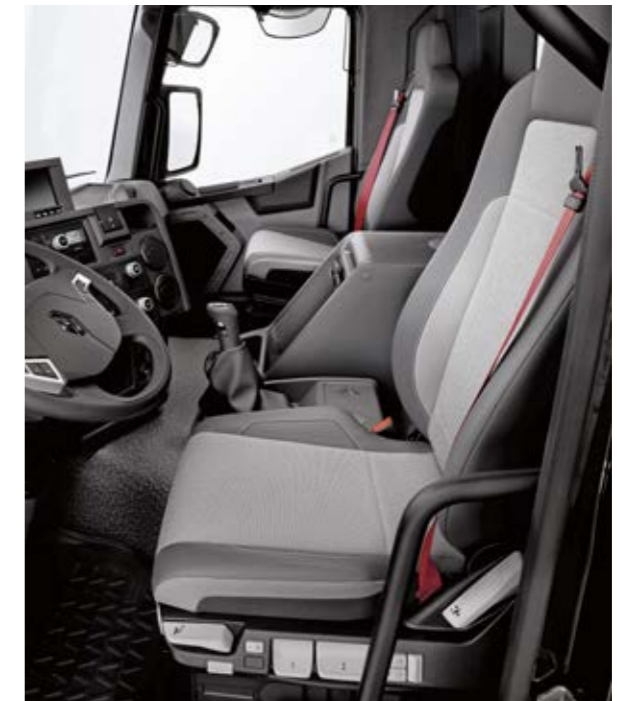
SEDILI A SOSPENSIONE PNEUMATICA CON CINTURE INTEGRATE, termici e ventilati. Poggiatesta, supporti laterali e supporto lombare regolabili. Corsa di 20 cm per fornire più spazio alle gambe.
