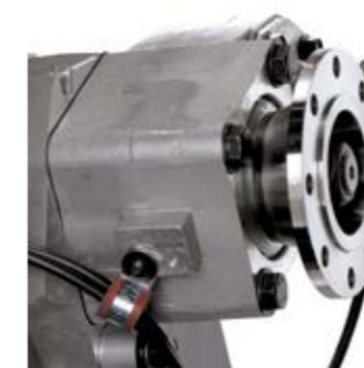
PRESA DI FORZA Per far funzionare gli allestimenti dei carrozzieri durante la marcia o da fermo.
