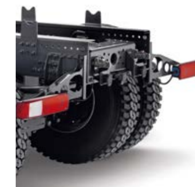
SBALZO POSTERIORE disponibile in moduli da 50 mm, per evitare il taglio dei longheroni.
