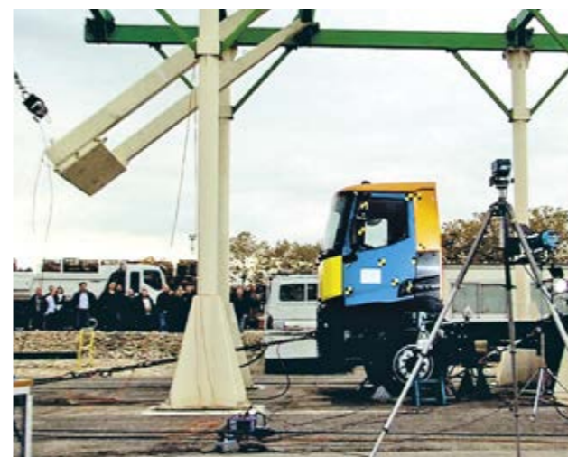
URTO FRONTALE per misurare la resistenza della cabina all'impatto.
