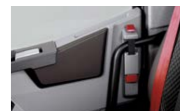
BLOCCAGGIO MECCANICO DELLE PORTE permette una chiusura supplementare delle portiere dall'interno del veicolo.
