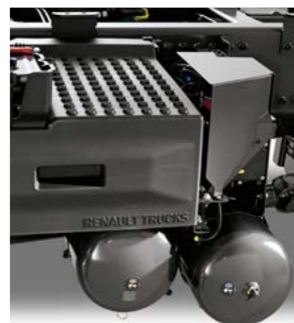
SCHERMI DI PROTEZIONE sui componenti esposti a urti: EACU, componenti pneumatici.
