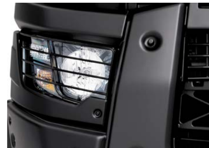
GRIGLIE DI PROTEZIONE DEI FARI e gruppi ottici in policarbonato di serie incassati nei paraurti, per assicurare una miglior resistenza all'impatto.
