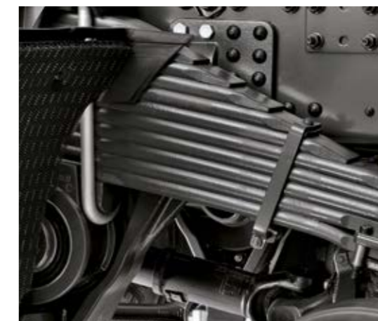
SOSPENSIONI SEMIELLITTICHE O PARABOLICHE 26 t parabolica 3 lame, 32 t semiellittica 11 lame, 32 t Xtrem parabolica 4 lame.
