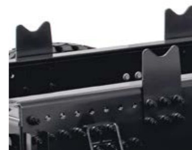
PIASTRE DI FISSAGGIO SU LONGHERONI per facilitare le operazioni di allestimento.
