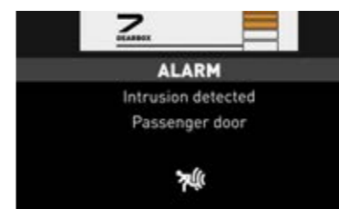
ALLARME ANTI-INTRUSIONE avvisa il conducente in caso di apertura delle portiere.
