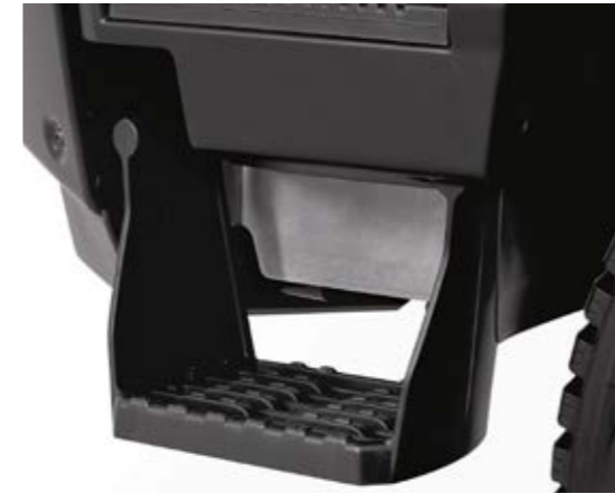
GRADINO FLESSIBILE con memoria di forma per resistere agli urti.
