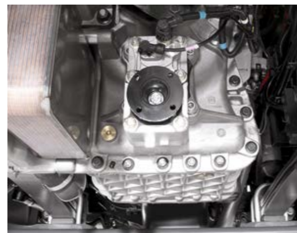
OPTIDRIVER XTREM dedicato agli utilizzi estremi, cava, trasporto e movimento terra, è dotato di un albero con sei settori dentati al posto di quattro, pignoni specifici e un programma di gestione dei cambi marcia che si adatta al carico del veicolo.
