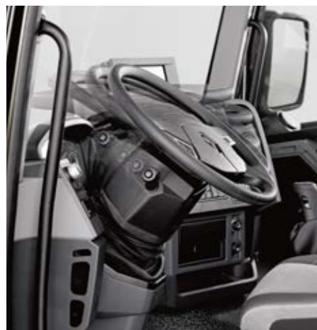
VOLANTE REGOLABILE IN 3 DIMENSIONI altezza, profondità, inclinazione.
