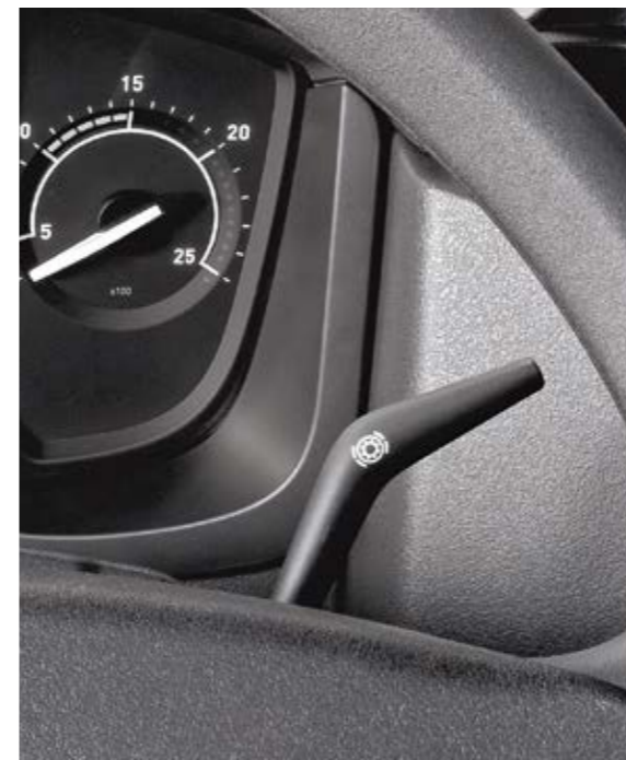
COMANDO DEL RALLENTATORE posizionato a destra del volante.
